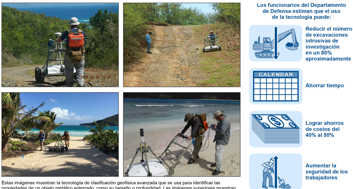
Figura 9: Tecnología de clasificación geofísica avanzada utilizada en los sitios de limpieza de Vieques y Culebra, Puerto Rico
