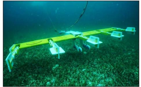
La imagen de la izquierda muestra un dispositivo de tecnología de clasificación geofísica avanzada en Culebra, utilizado para determinar las propiedades de un objeto metálico enterrado, como su tamaño o la profundidad que se encuentra el objeto. La otra imagen muestra un conjunto de magnetómetros remolcados en Vieques, Puerto Rico, que se usa para detectar anomalías magnéticas causadas por la presencia de objetos de hierro que están sobre el lecho marino o debajo de este.
